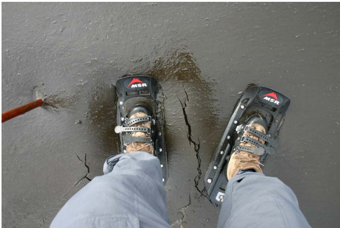
Mynd 1. Vaðið um Eyvafen 20. júlí 2005. Um 55 cm laus sandur er ofan á þéttari mól. (Landsvirkjun Victor Helgason, júlí 2005)
