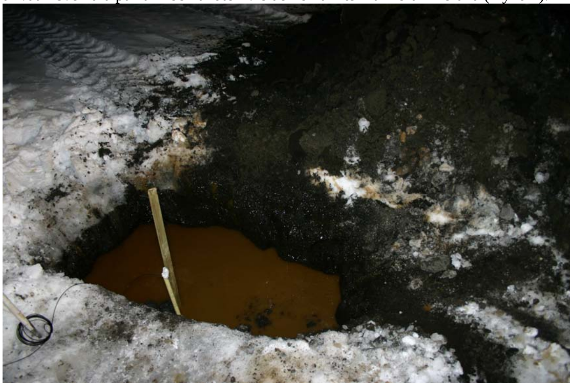
Mynd 4. Búið að grafa holu EYV02 og koma vatnshæðarskynjaranum fyrir á enda plaströrsins. Aflestrarkapallinn er í hönk á bakka holunar. (Landsvirkjun Victor Helgason, nóvember 2004)
