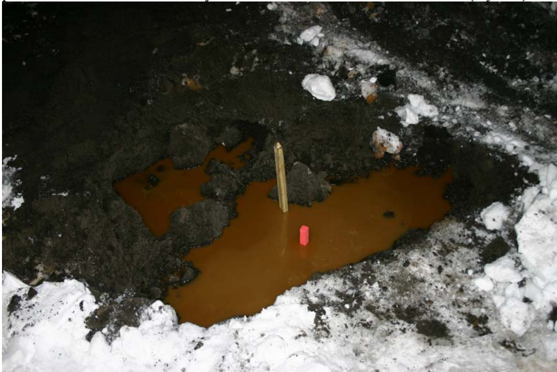
Mynd 5. Búið að koma vatnshæðarmæli fyrir í EYV02. Aflestrarkapallinn er í mölinni og rauði hællinn segir til um staðsetningu hans. Stóri hællinn var rekinn niður með plaströrinu. (Landsvirkjun Victor Helgason, nóvember 2004)
