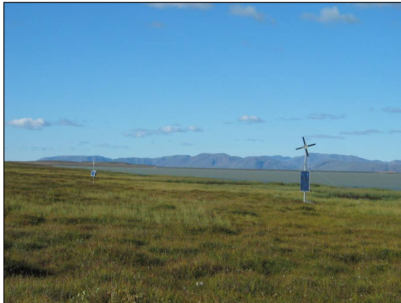
Mynd 5.2 Vindrafstöð og sólarcellur sem notuð voru til að útvega orku fyrir iðuflæðisturninn.
