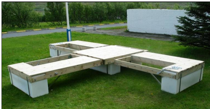
Mynd 3.2. Pramminn sem notaður var við mælingar á loftskiptum um yfirborð Gilsárlóns.
