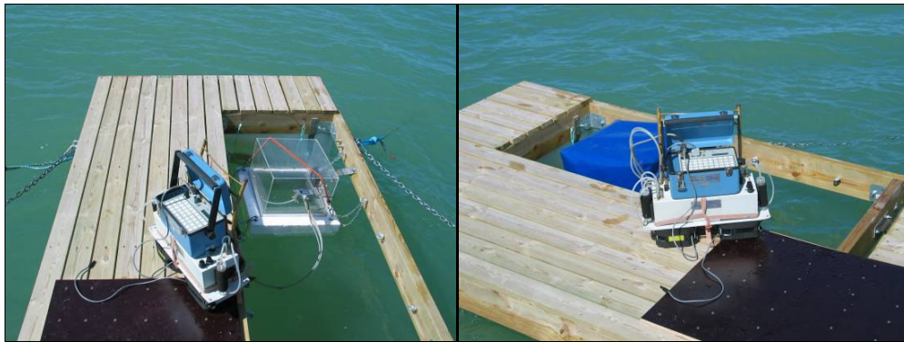
Mynd 5.37 Flotkragi eins og notaður var fyrsta árið við mælingar á flæði CO 2 . Til vinstri er mæliklefi festur á kragann. Mynd til hægri sýnir mæliklefa með skyggingu
