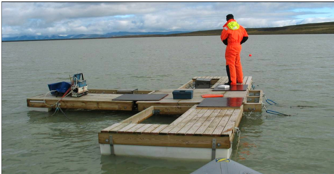
Mynd 6.1 Flotpramminn sem notaður var til mælinga á flæði \text{CH}_4 , \text{N}_2\text{O} og \text{CO}_2 um yfirborð lónsins. Pramminn var einnig notaður til vatnssýnatöku, til hitastigsmælinga og á tímabili til söfnunar loftbóla.
