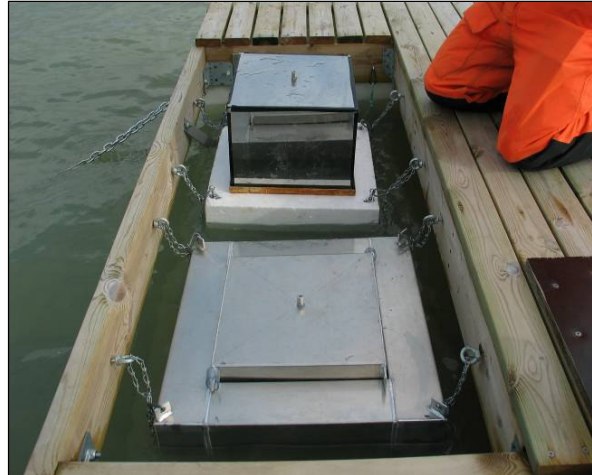
Mynd 6.2 Söfnunarklefar sem notaðir voru til að meta flæði CH_4 og N_2O . Frumgerðin er fjær á myndinni en endanlega útfærslan nær.
