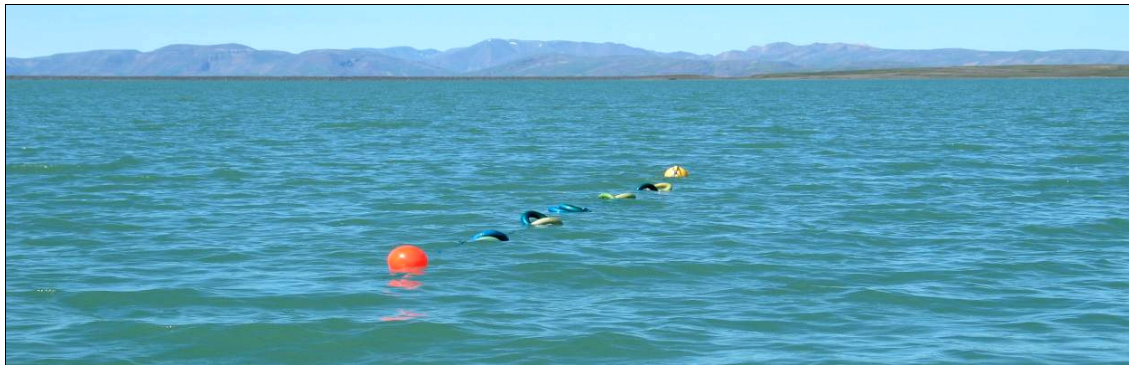
Mynd 6.7. Ein af þremur flotlínum með loftbólusöfnurum. Fjórir safnarar hanga neðan úr hverri línu.
