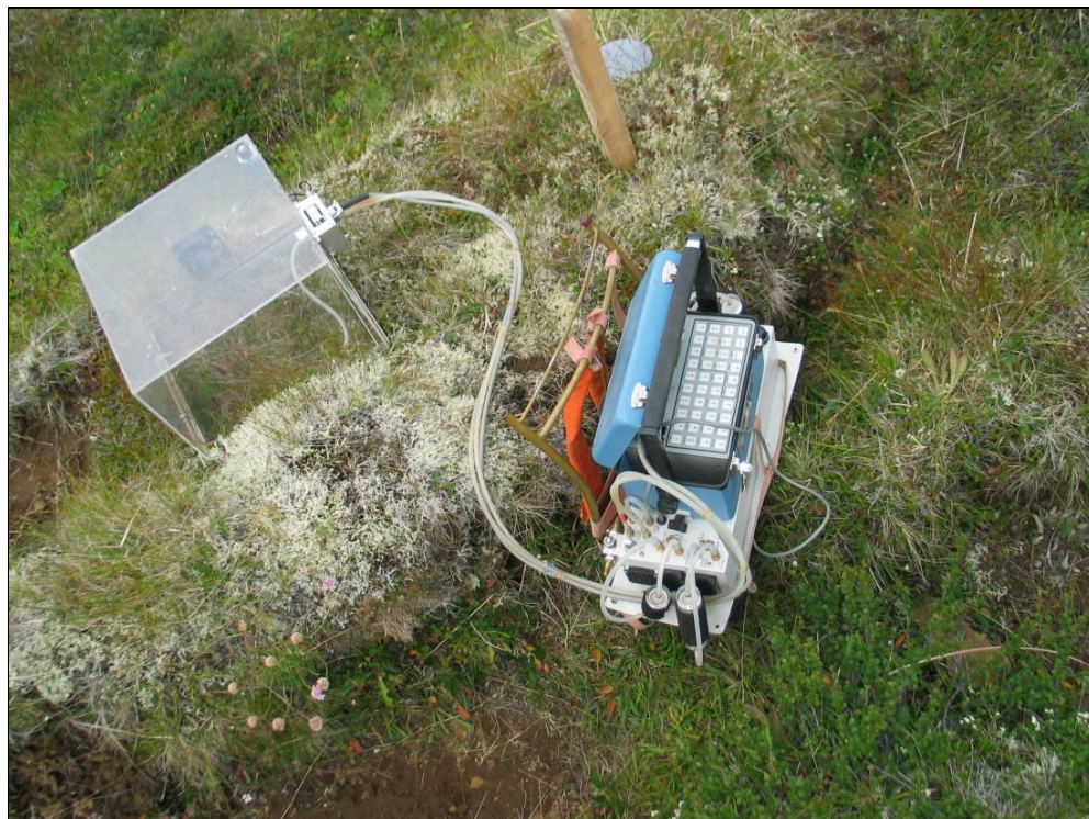
Mynd 8.1 Búnaður til mælinga á CO 2 upptöku og losun. Annars vegar mæliklefi og hinsvegar LICOR 6262 gasgreynir.
