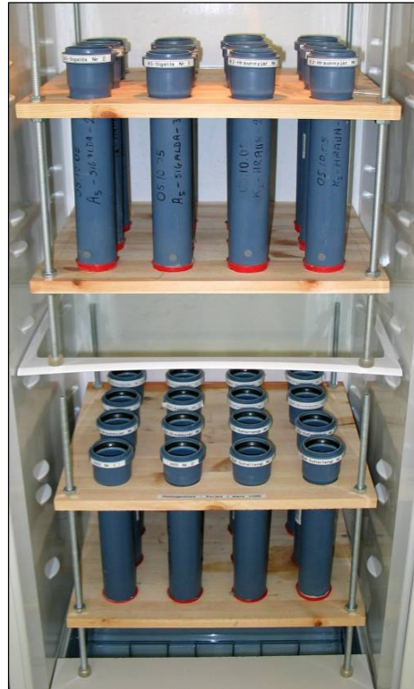
Mynd 9.4 Myndin sýnir uppsetningu hluta kjarnanna í hitastýrðum skáp.
