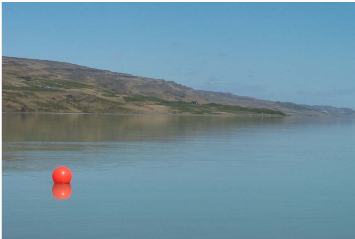
Mynd 3. Lóðabelgurinn sem heldur hitamælunum í Lagarfljóti á floti. Horft til norðurs (ljósmynd Landsvirkjun, VKH).
