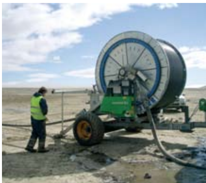
Slöngubúnaður til vökvunar á strönd Háslóns.
