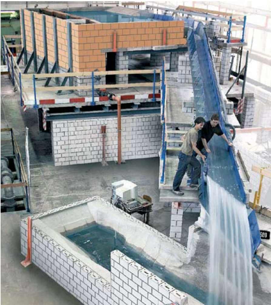
Líkanið af yfirfalli Háslóns var engin smásmíði í tilraunastofu tækniháskólans í Zürich. Hér er verið að prófa áhrif af hnöllum sem eru frammi á brú yfirfallsrennunnar og kljúfa vatnið í margar smærri bunur á leiðinni niður í gljúfrið.
