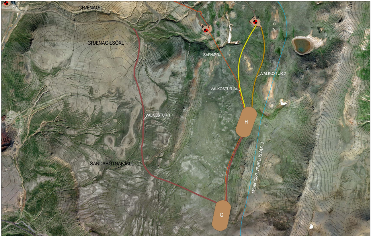
Mynd 5.5 Valkostir aðkomuleiðar að fyrirhuguðum borsvæðum uppi á Sandabotnafjalli. Á myndinni er einnig sýnd fyrirhuguð lagnaleið meðfram vegi á milli borsvæða og áfram meðfram valkosti 2a og þaðan að holu K-17.
