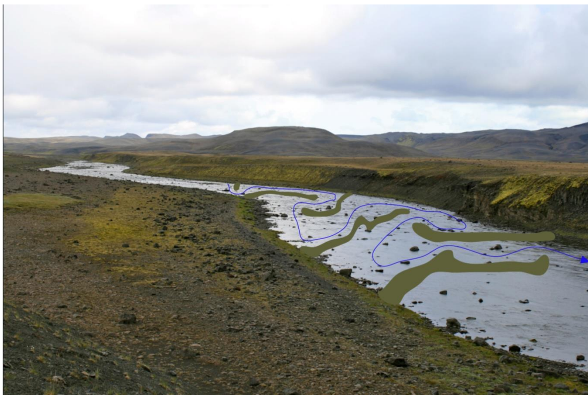
Mynd 6. Leiðigarðar úr grjóti og aðlögun farvegar að bergvatnsrennsli. Myndin lýsir mögulegri útfærslu á tilraunakafli. Leiðigarðar liggja frá landi og upp með straumi, að hluta, þannig að uppistaða vatns myndist. Straumstefna árinna er frá vinstri til hægri eins og bláa örin sýnir.
