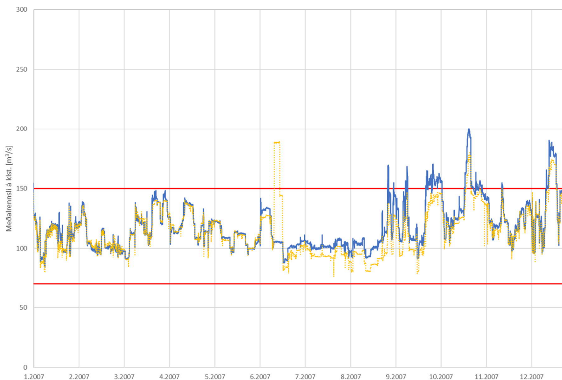
Mynd 2 Rennsli Sogs við Ásgarð, Vhm 271, árið 2007 (blátt), samanlagt rennsli um vélar Írafossstöðvar og framhjärennslis (gult) og viðmiðunarmörk rennslis frá Írafossi (rautt).
