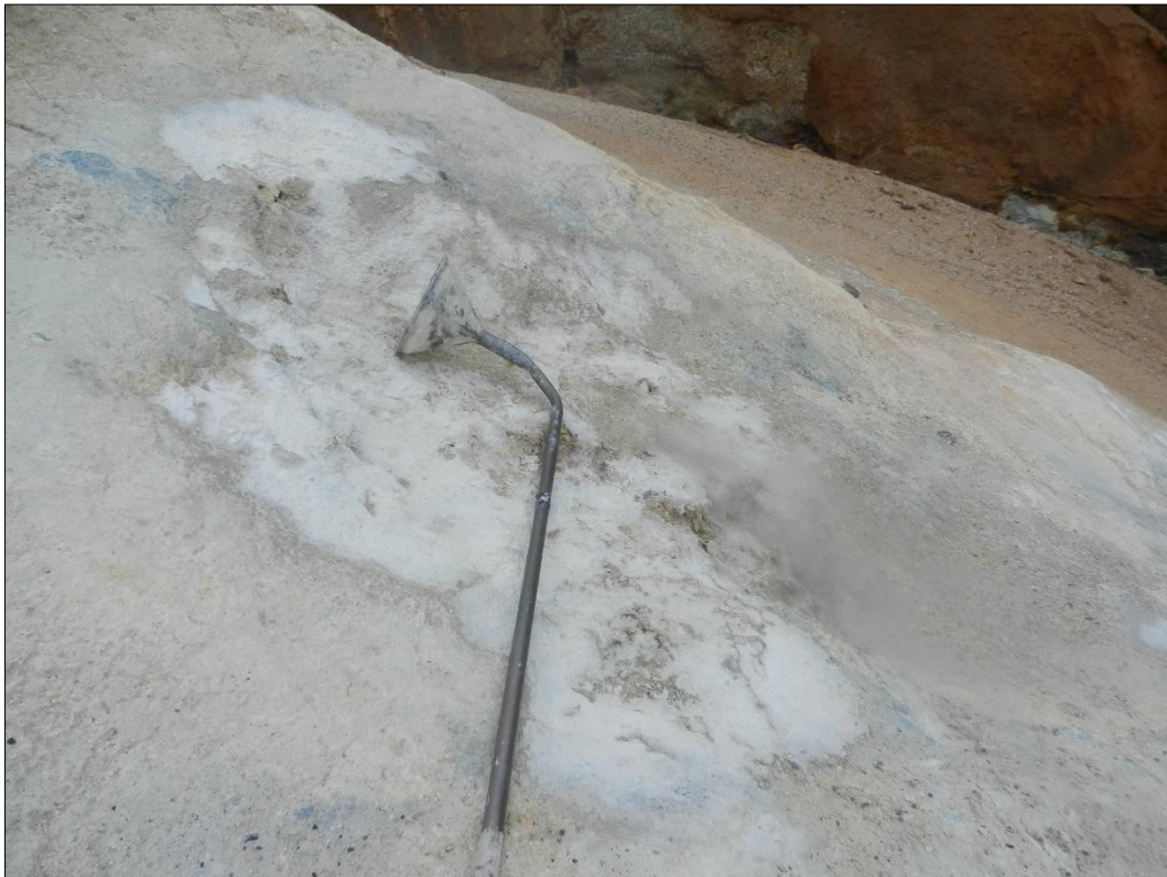
Mynd 30. Undirbúningur gufusýnatöku úr gufuauganu K G-106 í gili vestan við holu K-14.
