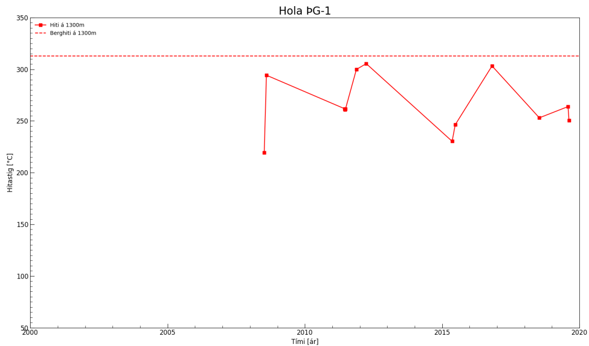
Mynd 34. Hin stutta saga hitastigs á 1300 m dýpi í holu ÞG-1. Mælingarnar árin 2018 og 2019 eru þær fyrstu sem eru hluti að eftirlitsmælingaferli í holunni.
