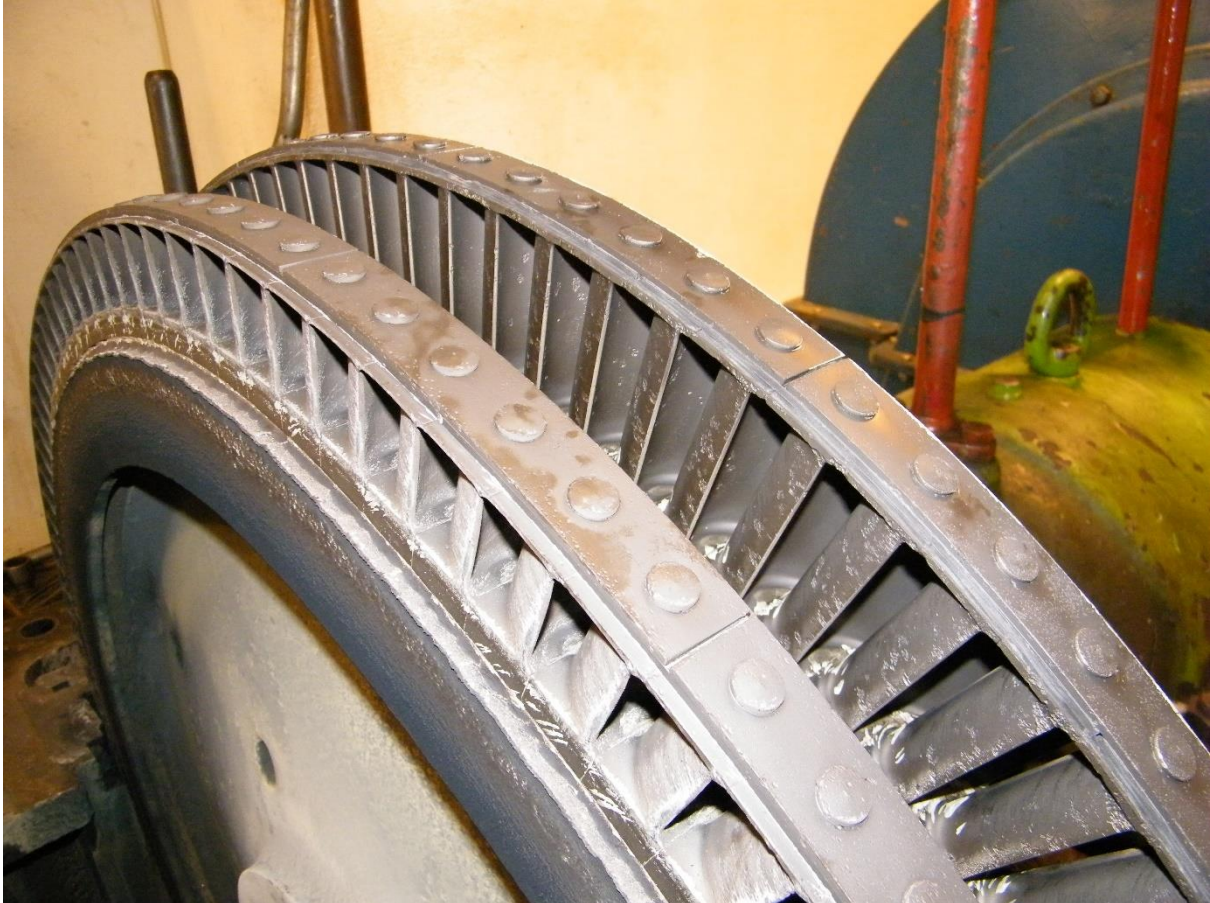
Mynd 7. Nærmynd af hverfilhjólínu sem sett var upp 2001. Mynd tekin í vélaupptekt í gufuaflstöðinni. Mynd í eigu Landsvirkjunar.
