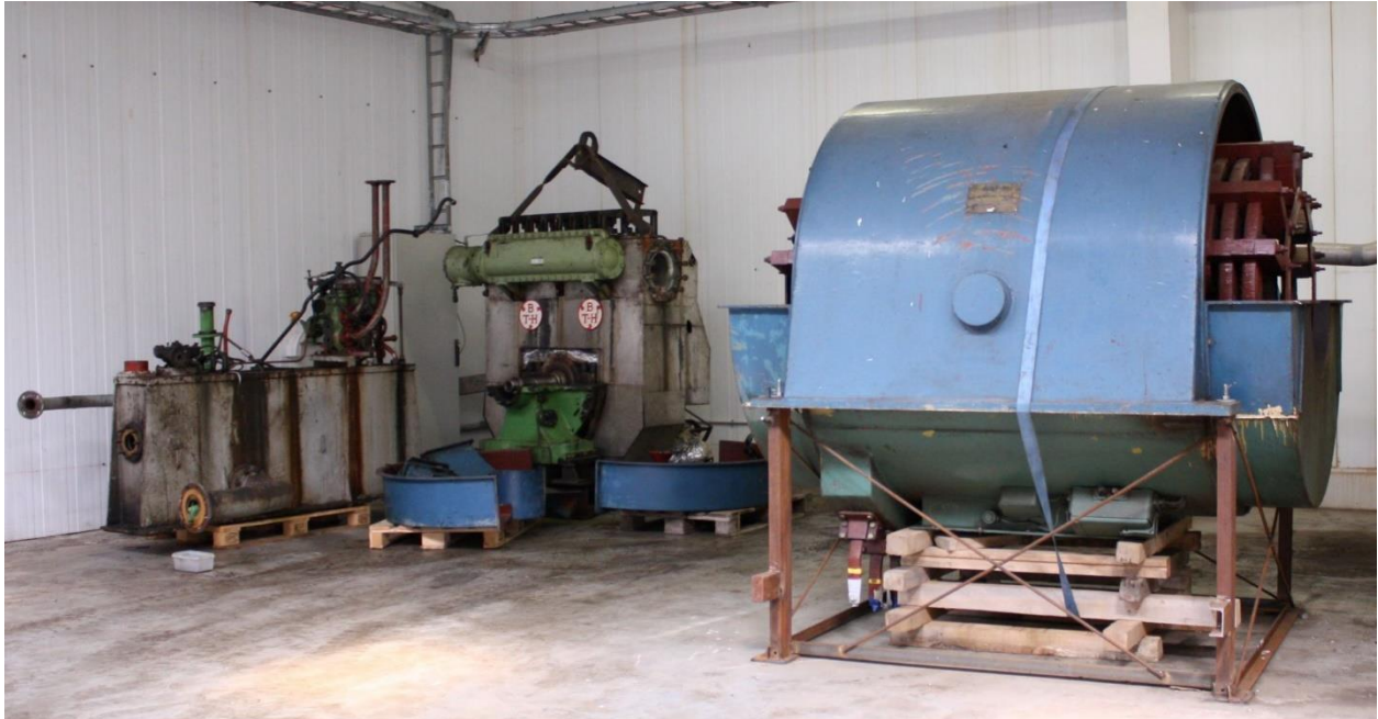
Mynd 9. Gufuhverfillinn í geymslu Landsvirkjunar. Á mynd sést rafall, hlífar á rafal, olútankurinn og aðalvélin.
