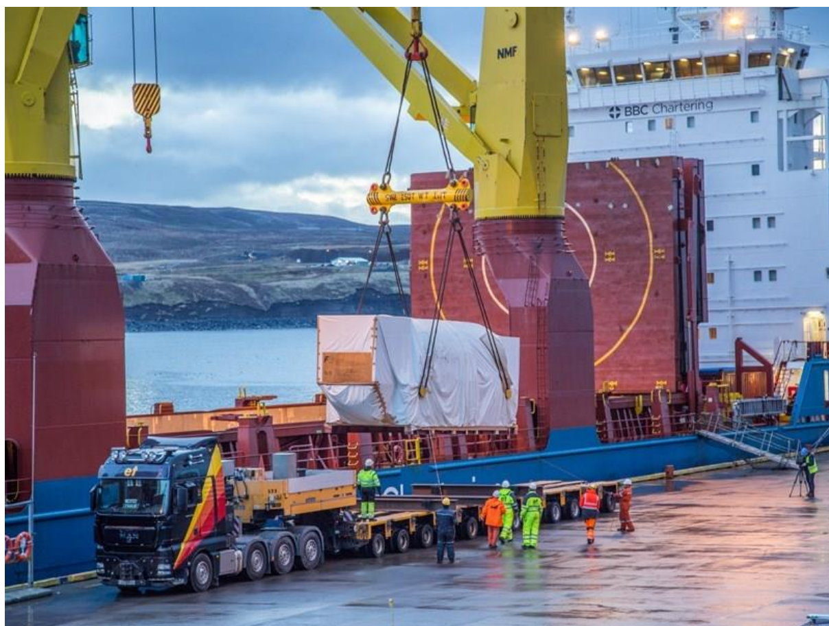
MYND 9 Rafall fyrstu vélasamstæðu þeistareykjavirkjunnar hífður af borði flutningsskipinu BBC Polonia í desember 2016. Ljósmynd: Landsvirkjun.
