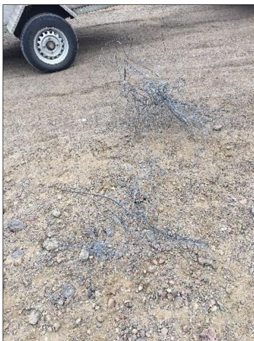
Mynd V4. Vírhankir sem náðust úr holu KJ-33 þann 11.júní 2020. Hluti vírs sem tapaðist í körfumælingu árið 2002.
