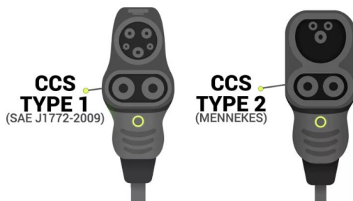
Mynd 20: Type 1 og Type 2 tenglar fyrir hraðhleðslu rafmagns á stærri ökutækis
