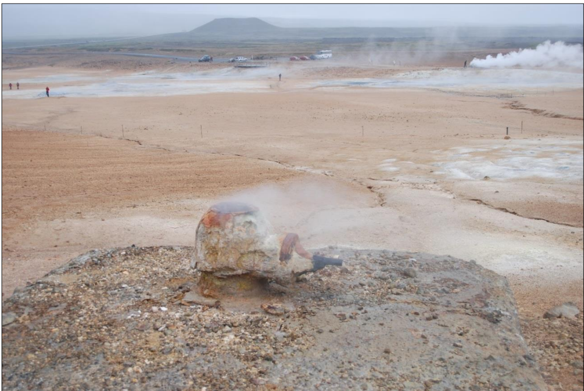
Mynd 62. Hola 5. Eins og í fyrra gufar nokkuð upp um holurnar, einnig þá syðri (holu 4). Nokkur brennisteinn var umhverfis holutoppinn á holu 4 eins og í fyrra. Á svæðinu fyrir neðan var þunn skán yfir öllu (myndlaus kísill, brennisteinn og hverasölt) og hiti mældist yfir 95°C.
