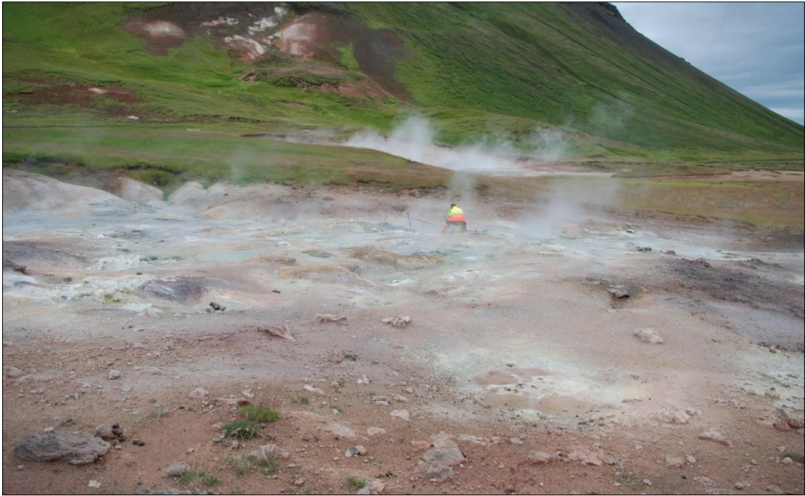
Mynd 91. Sýnataka úr Þ G-103 en virkni þar var svipuð og í fyrra. Hiti við sýnatökustað var 98°C. Skellan er öll heit með brennisteinsútfellingum við gufustreymi, myndlausum kísli og hverasöltum.
