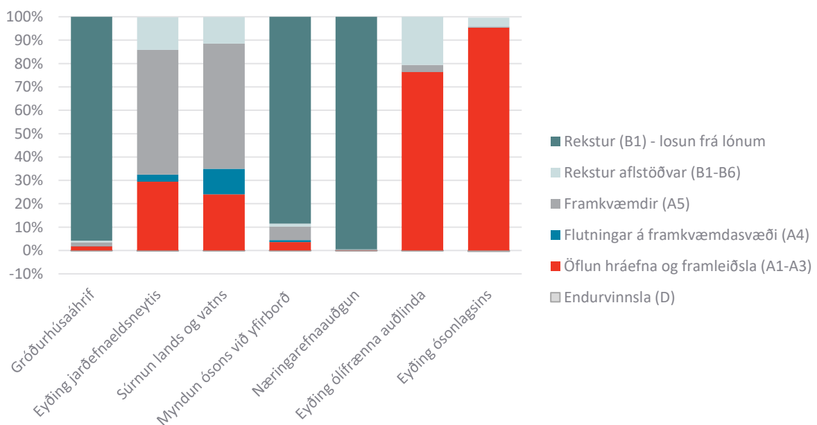
MYND 4 Umhverfisáhrif frá vinnslu 1 kWst raforku í Blöndustöð. Á myndinni má sjá hlutdeild mismunandi þátta vistferils aflstöðvarinnar á 100 ára líftíma fyrir hvern flokk umhverfisáhrifa.
