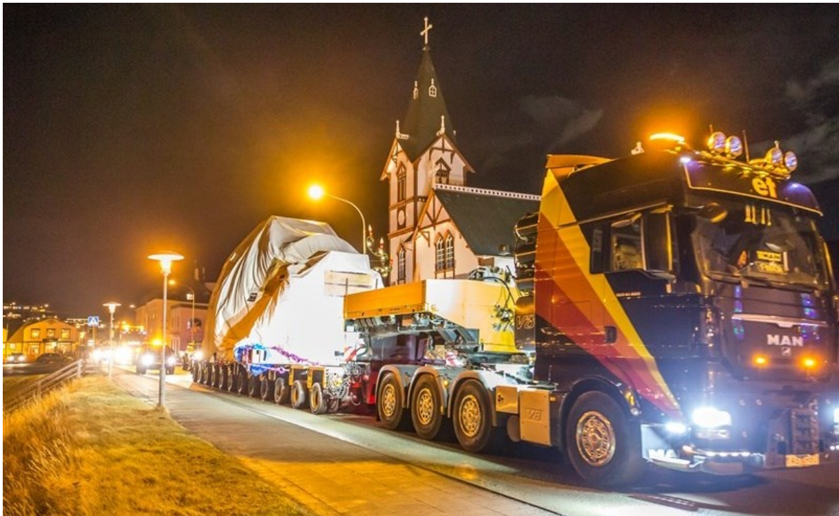
MYND 10 Ekið með hverfil fyrstu vélasamstæðu Þeistareykjavirkjunar um götur Húsavíkur í desember 2016. Hverfillinn vegur um 134 tonn. Ljósmynd: Landsvirkjun.
